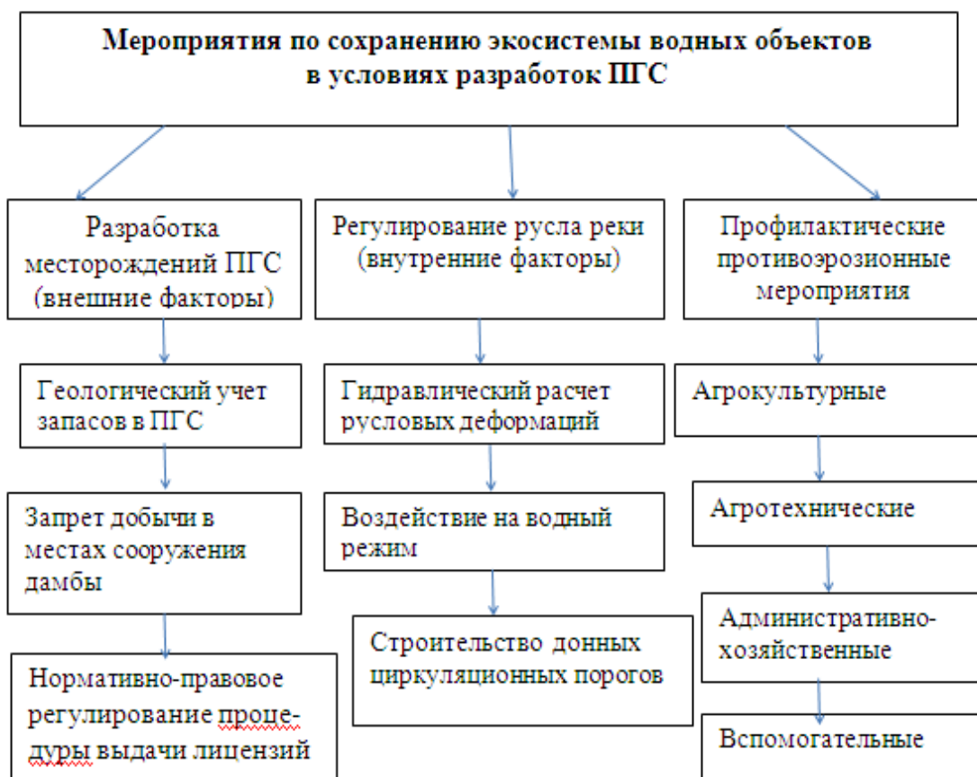
Рис.2. Обобщенная схема инженерно-технических мероприятий по защите экосистемы водных объектов от негативного воздействия добычи полезных ископаемых.
