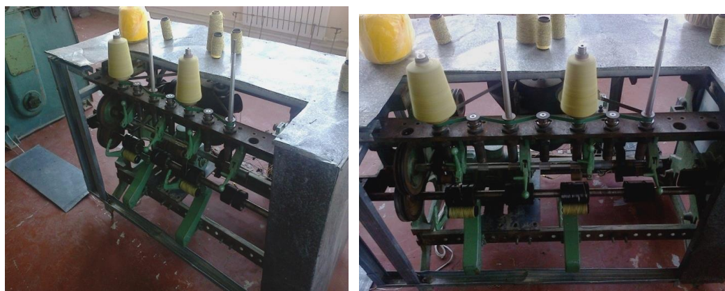
Рис.2. Устройство для кручения пряжи
