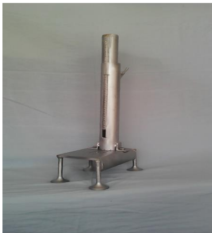
Рис. 1. Прибор для определения силы нарезки овощей.
