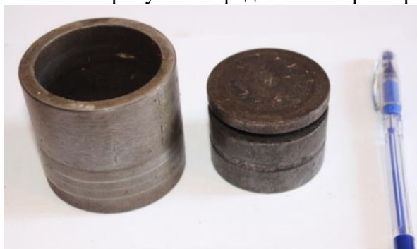
Рис. 6. Прессформа и пуансон для получения брикетов.
