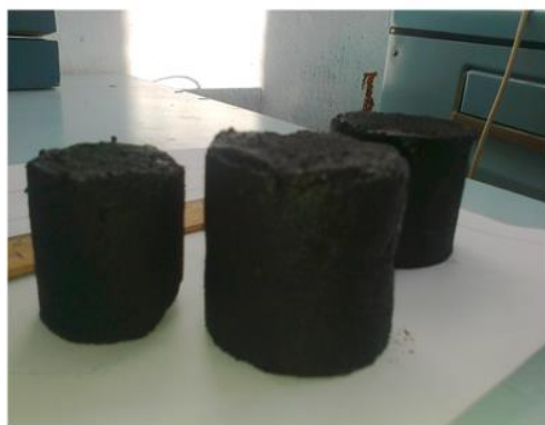
Рис. 10. Фотографии брикетов из Кожокеленского угля полученные с 10% - ным декстрином с разными диаметрами.
