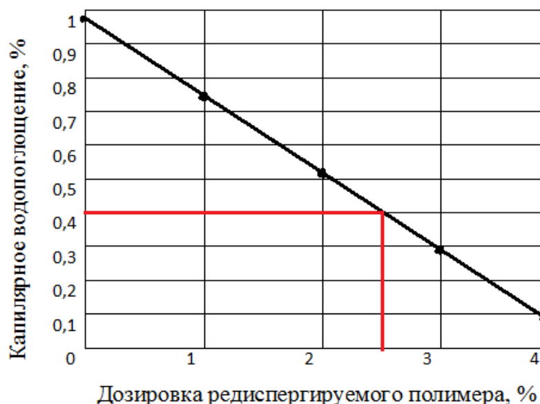
Рис. 4. Влияние редиспергируемого полимера на капиллярное водопоглощение штукатурного раствора на основе известково-песчаной смеси
