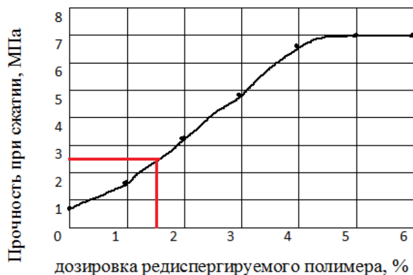
Рис. 2. Влияние редиспергируемого полимера на прочность при сжатии штукатурного раствора на основе известково-песчаной смеси
