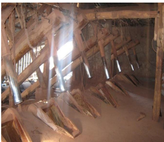
Рис.5. Общий вид рабочего органа мельницы для обмолота риса.
