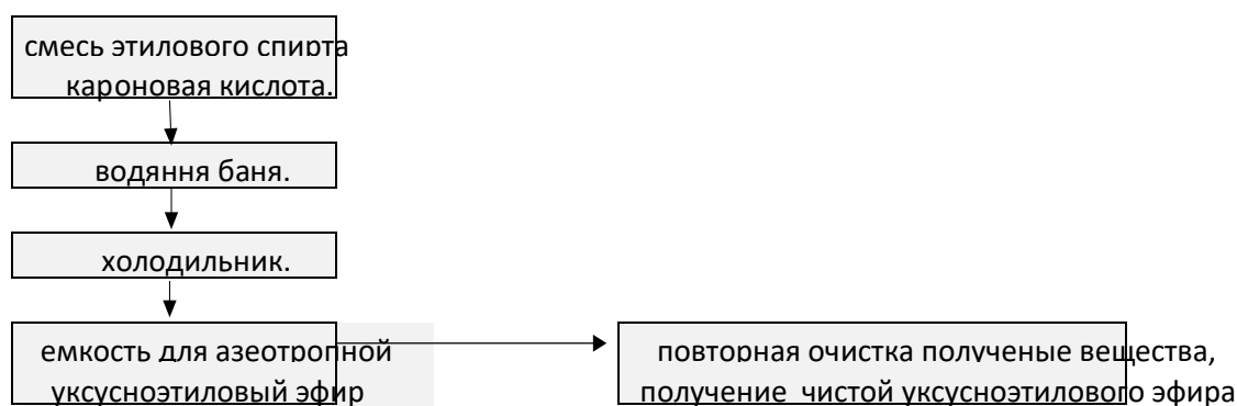
2-сүрөт. Карбон кислоталарынан этилацетил эфири алуунун технологиялык схемасы.
