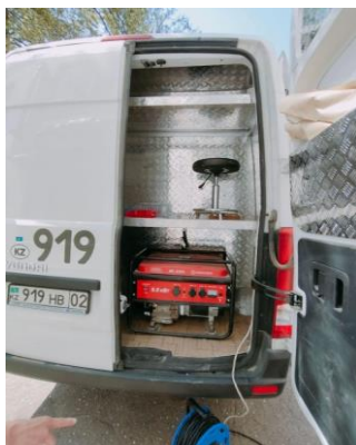
Рис.12. Генератор MC6500 для обеспечения бесперебойного питания для необходимого оборудования
