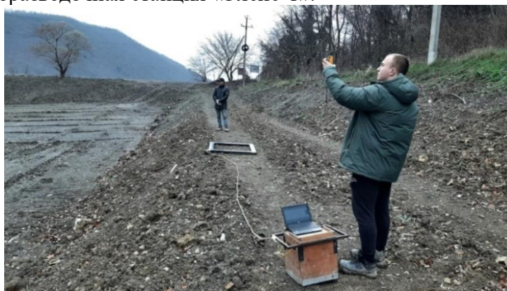
Рис. 4. Процесс проведения геофизических исследований на участке изысканий
