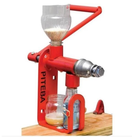
Рис. 1. Отжим сафлорового масла с помощью ручного шнекового маслопресса «РІТЕВА».
